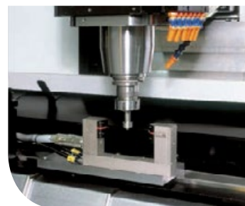
Taratura utensili laser Laser tools setting device
