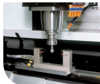
Taratura utensili laser Laser tools setting device
